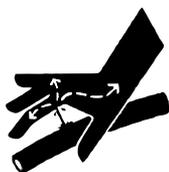
Não verifique vazamentos em cilindros hidráulicos com as mãos, jatos de alta pressão podem provocar ferimentos.
