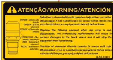
Ao realizar a troca dos elementos dos filtros de alta pressão da esteira e dos discos, também deve trocar o filtro de retorno e fazer a limpeza do filtro de sucção.
